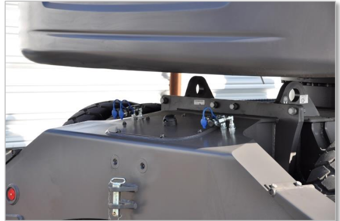
Ventiluttag för broms, tipp och strö, samt släpvagnskontakt
